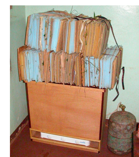
4b) A gas-powered herbarium drying apparatus. Design of the Herbarium de l'Université de Ouagadougou, Burkina Faso.
